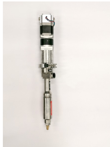
Voolu peatamist ja jätkamist võimaldav ekstruuder
